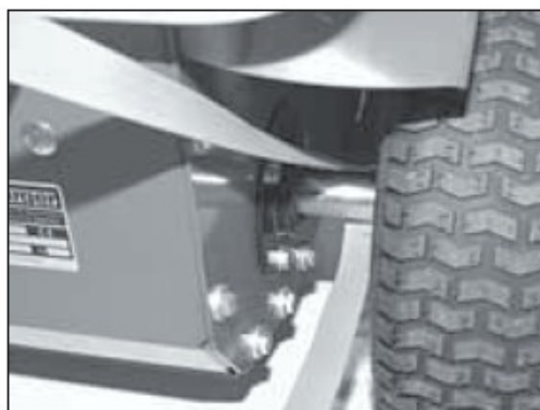
4. Используйте заднюю ось как точку фиксации.
